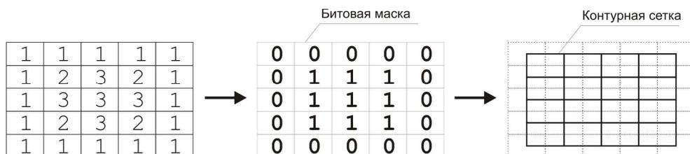
Рис 1. Матрица значений, ее битовая маска ( $L=1$ ) и контурная сетка (пример)
