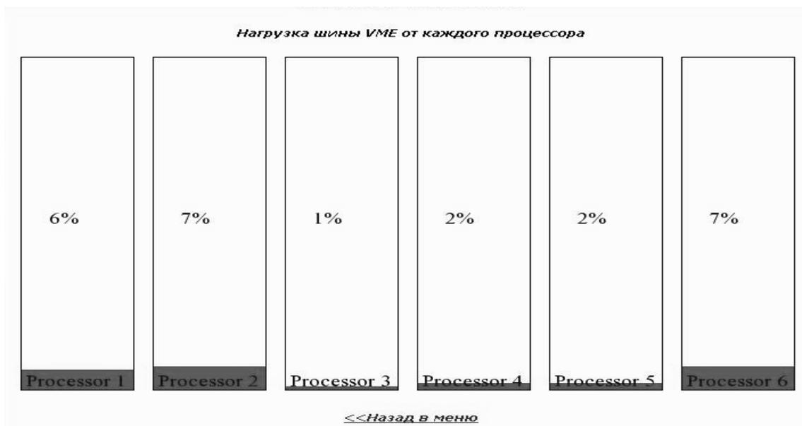
Рис 6. Пример отображения информации о загрузке шины VME
