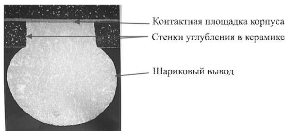
Рисунок 1. Крепление шарикового вывода в корпусе типа DBGA
