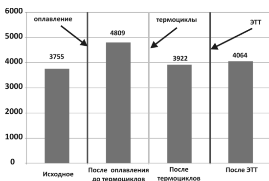
Рисунок 6. Группа 1. Влияние оплавления в самом начале маршрута на усилие сдвига выводов
