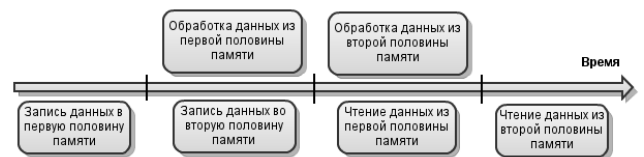
Рис. 1. Временная диаграмма параллельной работы DMA-контроллера и сопроцессора CP2
