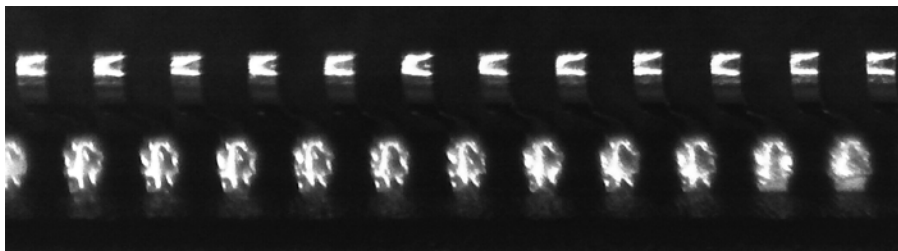
Рис. 10. Участок выводов идеального качества после термообработки
