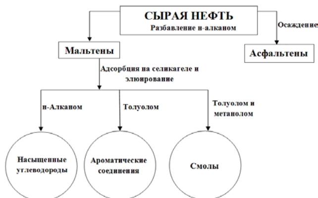
Рис. 4. Блок-схема разделения сырой нефти SARA-методом
