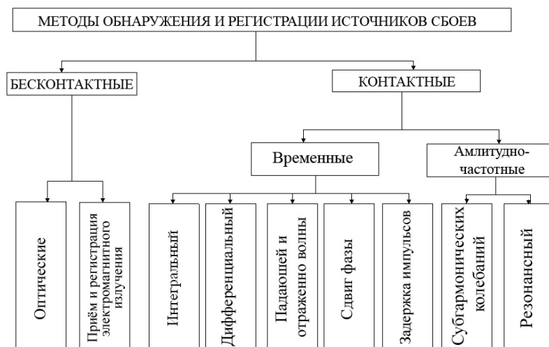
Рис.1. Классификация методов обнаружения и регистрации источников сбоев
