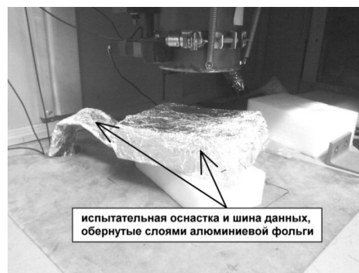
Рисунок 4. Экранирование испытательной оснастки от воздействия внешней ЭМ помехи при испытаниях
