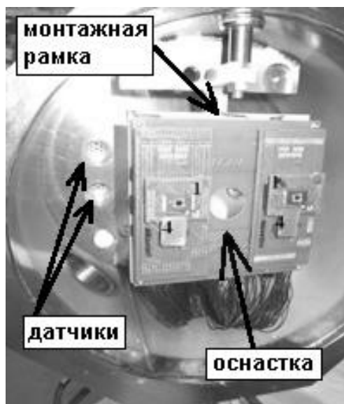
Рисунок 5. Монтаж оснастки во время эксперимента на ускорителе ионов
