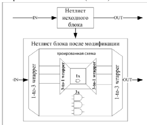
Рисунок А. Тройное резервирование блоков микросхемы 1907BM044
