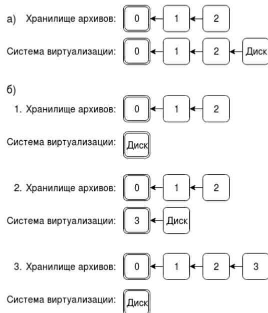
Рис. 1. Процесс архивирования: (а) с двумя параллельными цепочками снимков виртуальных дисков, либо (б) с переносом изменений со времени последнего архивирования; {диск} – текущий снимок, в который выполняется запись данных виртуальной ОС; {0} – начальное состояние дискового устройства. Блоки с двойной рамкой обозначают самодостаточный виртуальный диск, с одинарной – снимок диска, ссылающийся на другой снимок или диск.
