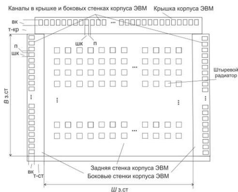
Рис. 4. Боковые стенки, крышка корпуса с каналами, через которые нагнетается воздух от ЦВСО и задняя стенка корпуса ЭВМ с штыревым радиатором
