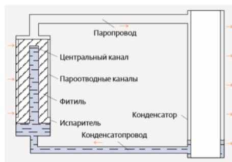
Рис. 3. Принципиальная схема КТТ [3]
