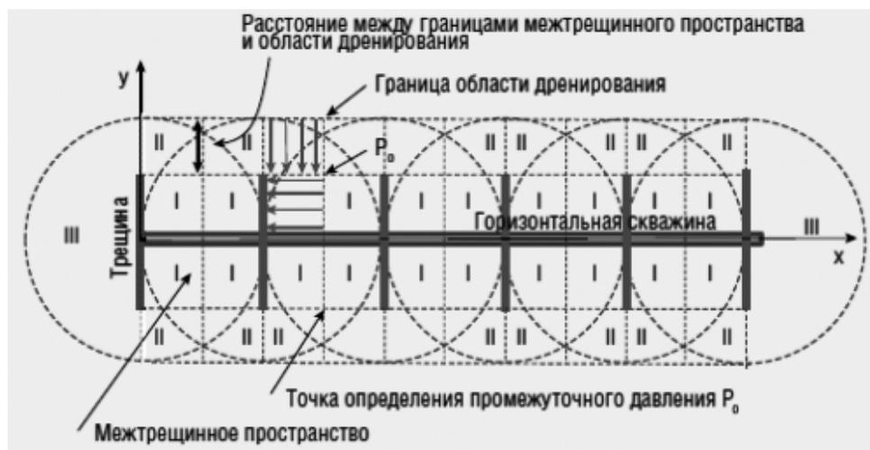
Рис. 5. Геометрия задачи. Расположение зон дренирования трещин на горизонтальной скважине. Образование общей зоны дренирования и ее сегментирование [10]
