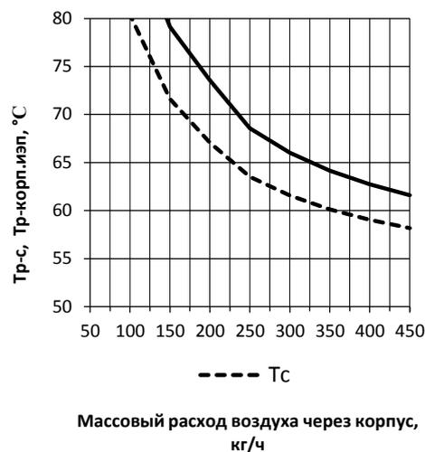
Рис. 6. Результаты расчета зависимостей температуры  $T_{p-c}$  на радиаторе корпуса микропроцессора и температуры  $T_{p-корп.ИЭП}$  на радиаторах корпуса ИЭП от массового расхода воздуха через корпус
