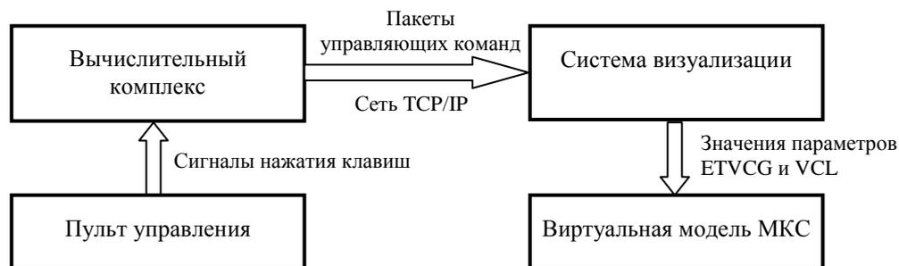
Рис. 8. Структура системы виртуального окружения МКС
