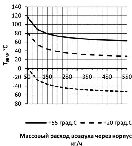
Рис. 6. Рассчитанные температуры ( $T_{\text{ЭВМ}}$ ) корпуса ЭВМ в зависимости от массового расхода воздуха при температурах среды +55 °С, +20 °С, -60 °С и пониженном давлении 2000 Па (15 мм.рт.ст.).
