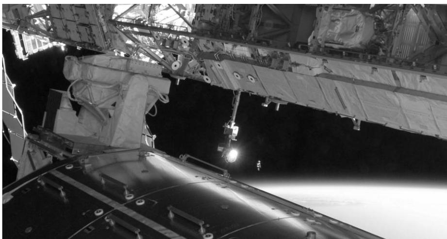
Рис. 2. Подсветка внешней поверхности МКС с помощью осветителя в блоке ETVCG
