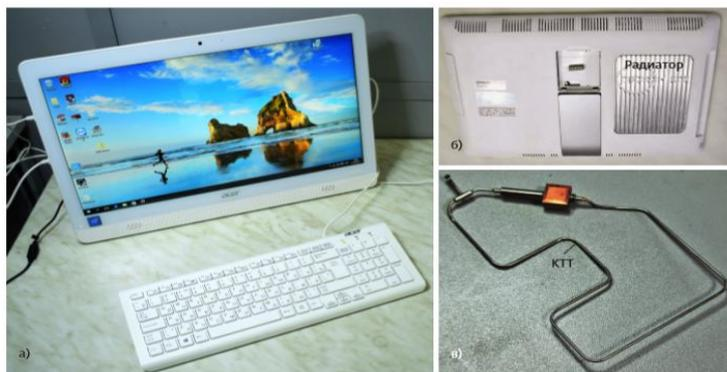
Рис. 4. Моноблок охлаждаемый КТТ: а – внешний вид, б – вид со стороны задней крышки, в – КТТ [3]
