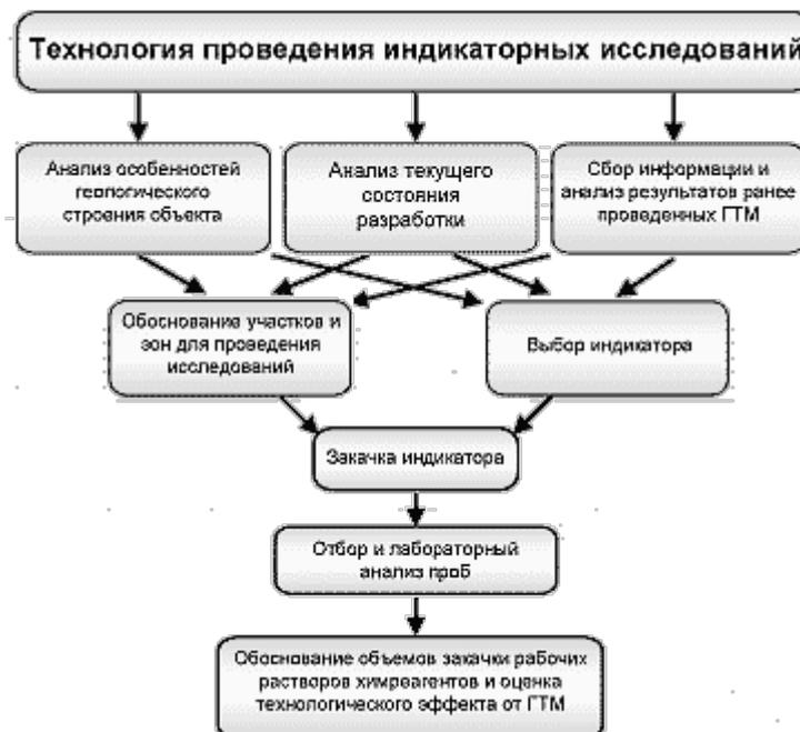
Рис. 2. Схема трассерного метода [20]
