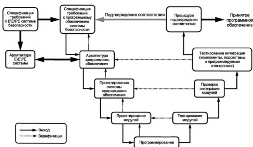
Рис. 2. Жизненный цикл разработки программного обеспечения (V-цикл; МЭК 61508-3, рисунок 6)
