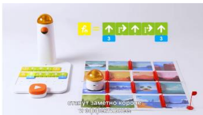
Рис. 5. Слева – управляющая башня набора и выложенная на ее пьедестале программа. Справа – игровое поле, по которому движется управляемый башней робот («водитель» виден через прозрачный оранжевый купол водительского отсека). Выше игрового поля показана крупным планом фрагмент управляющей программы – подпрограмма с именем f0.
