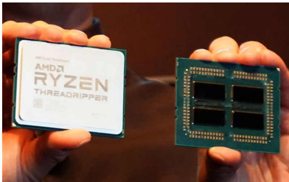
Рис. 5. Процессор фирмы AMD Ryzen Threadripper, выполненный по технологии чиплетов
