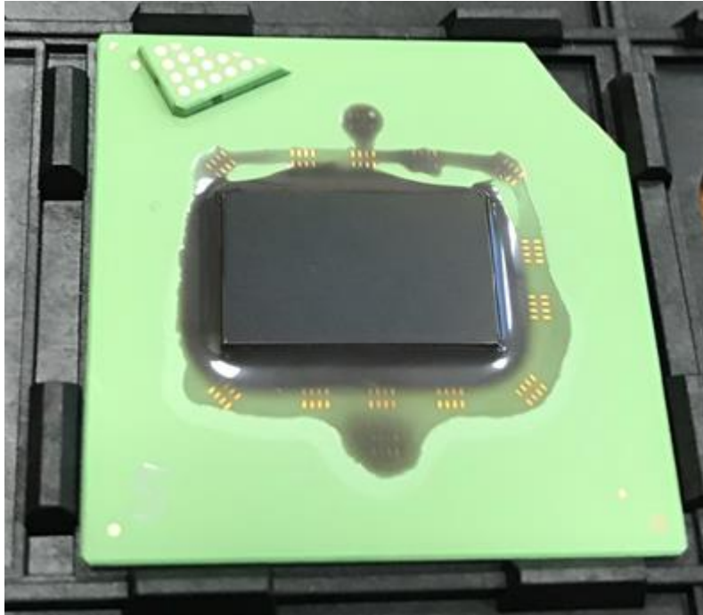
Рис. 2. Разрушение подложки из LTCC керамики
