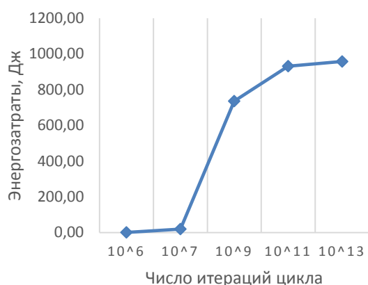
Рис. 5. Энергозатраты на операцию записи символа в файл в зависимости от числа итераций
